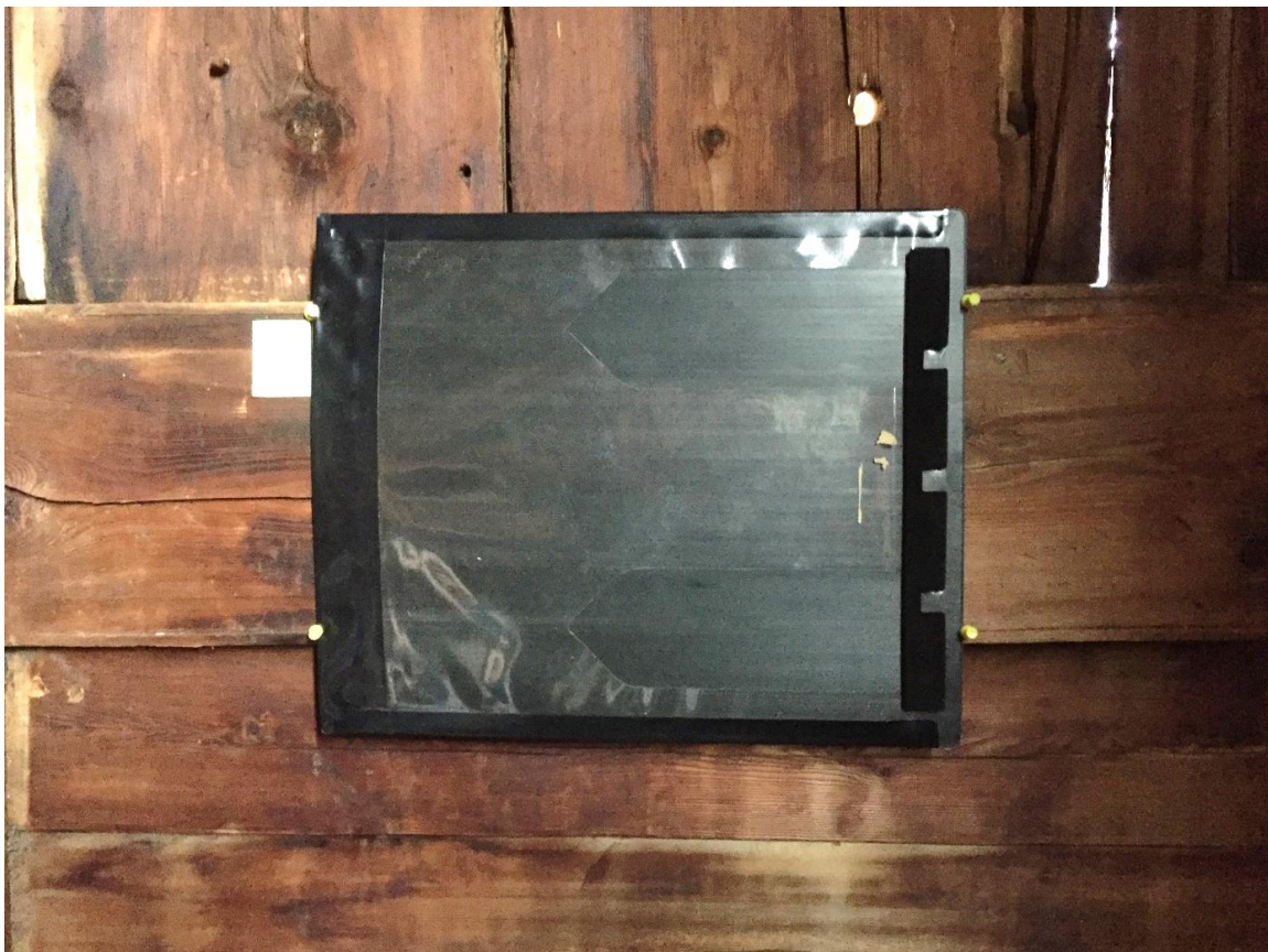
Figur 3, a-b. Røntgenoppsett. 3a: Røntgenapparatet var plassert på lift på utsiden av kirken. 3b: Røntgenfilmen var plassert på veggen på innsiden av kirken Foto: NIKU.
