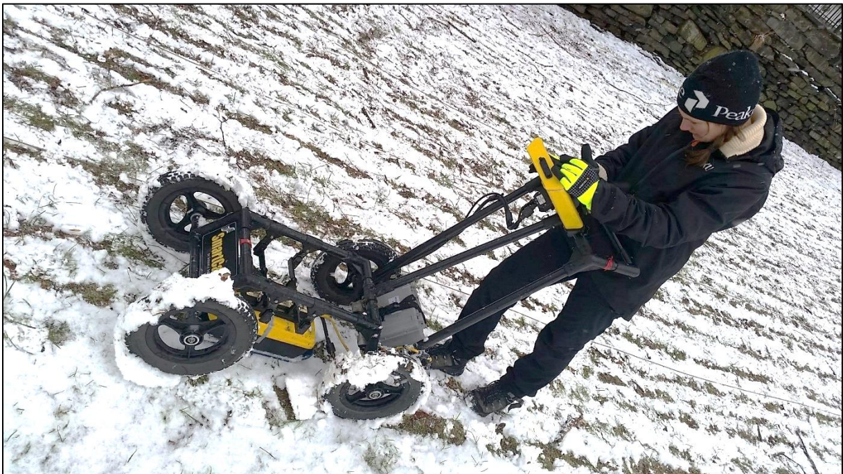
Figur 4: Georadarantenne av typen Sensors & Software Noggin 500 brukt ved undersøkelsen av Peterskirketomten. Foto: LG/NIKU.
