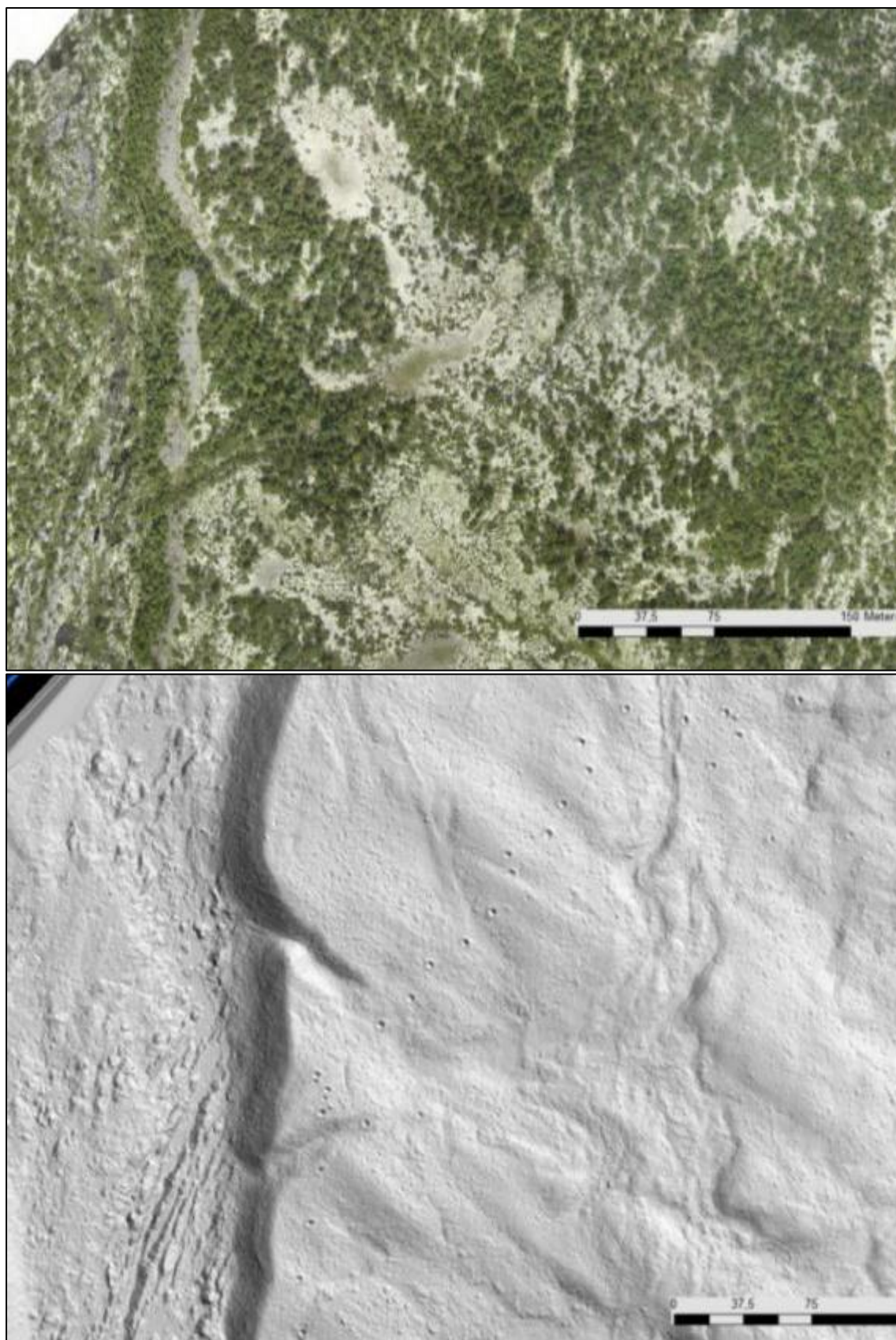
Figur 7.17: Et flyfoto (ortofoto) og en digital terrengmodell (DTM) av et område hvor det finnes fangstgroper. Flyfotoet gir ikke grunnlag for å observere kulturminnene på bakken, mens de kommer tydelig frem på den lasergenererte DTMen. DTMen er basert på de laserpunkter som traff bakken under skanningen, mens punkter som har truffet tre kroner og øvrig vegetasjon er filtrert bort.
