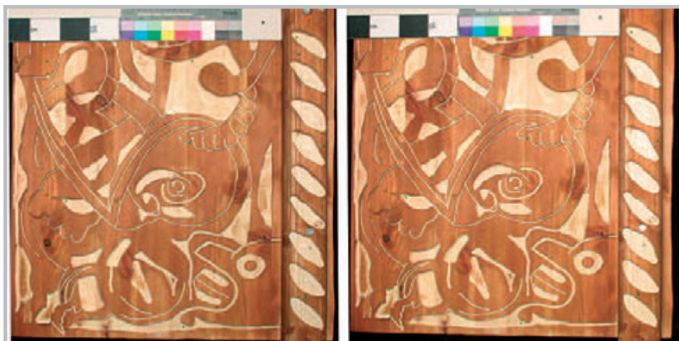
Figur 3. Prøveplaten fotografert to ganger med 20 cm forskjell i kameraposisjon. De to bildene ser tilsynelatende like ut, men den lille avstandsforskjellen gjør det mulig å betrakte dem tredimensjonalt. Prøv med et lommestereoskop, et gammeldags hjemmestereoskop eller hold en papplate opp mellom bildene og betrakt dem slik at hvert øye blir tvunget til å fokusere på hvert sitt bilde. Med litt trening vil en da kunne se dybdeforholdene i modellen.
