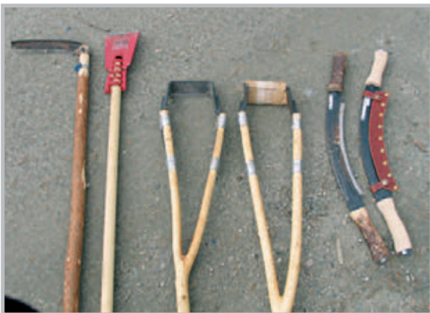
Figur 4. Barking. Redskaper til barking. Fra høyre to barkekniver, eller såkalte bandkniver, fra Verktøysmia, Jon Dahlmo ( www.dahlmo.no ). Deretter to spesiallagde kniver til å jobbe høyt oppe med, mens man står på bakken. Også disse er smidd av Dahlmo på bestilling. De fungerte bra, men var tunge å jobbe med i lengre økter, selv om skaftene var stabile og laget i et lett treslag. Nest bortenfor til venstre er en vanlig barkespade på en rundstokk. Denne fungerte ikke godt til dette bruket, og rundstokken ble for myk. Lengst til venstre et gammelt ljåblad, litt kortet ned og satt på et langt og stabilt, men lett skaft, tilpasset av Steinar Moldal. Denne fungerte fint når barken ikke var alt for grov.
