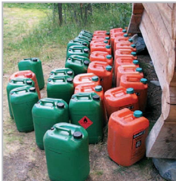
Figur 22. Tjærebrenning. Tjæra ble tappet på 25 liters plastkanner. Alle kannene ble merket med starttidspunkt og sluttidspunkt, slik at vi også fikk dokumentert produksjonshastigheten (flow rate). Det ble også tatt mindre prøver for analyse for hver fjerde dunk, dvs. med et intervall for hver 100 liter produsert tjære. Brenningen ble slokket med vann 56 timer etter påtenning, og nettoutbyttet av tjære var på 675 liter av en mengde tyrived på ca. 25 kubikkmeter tett stablet. Nettoutbyttet vil si det kvantum av tjære som er igjen etter at lågen er skilt fra.
