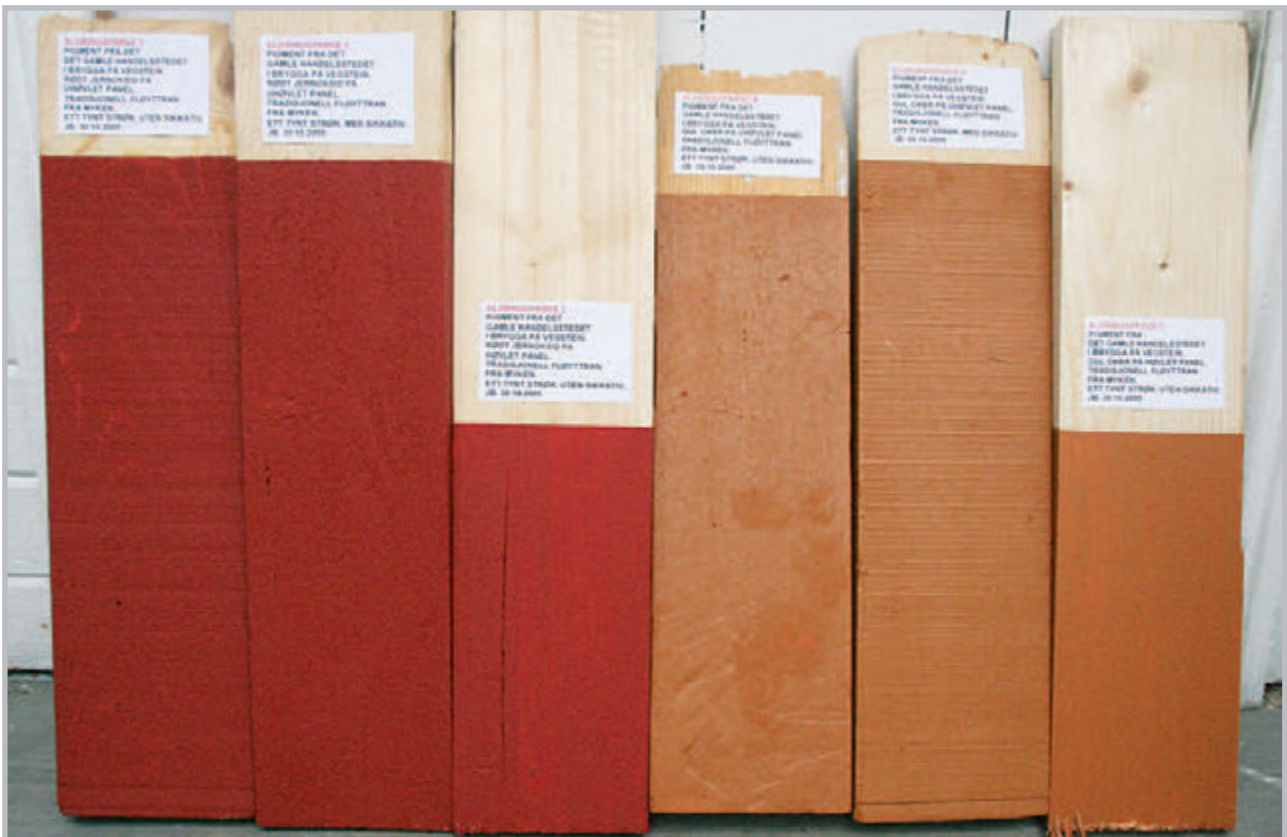
Figur 11. Aldringsprøver. Prøvene er malt opp med pigmenter fra den gamle handelsboden på Vegstein og fløytran fra Myken. Det er satt opp prøver med og uten sikkativ og på høvlet og uhøvlet panel. Malingen dekker usedvanlig godt med bare ett strøk. Malingen med rødt jernoksidpigment, med tilsetning av sikkativ, tørker over natten. Uten sikkativtilsetning er tørketiden to døgn. Prøvene ble satt ut til tørk i fuktig høstvær. Prøvene med gul oker hadde som forventet vesentlig lengre tørketid; 5-6 døgn. Foto J. Brænne. 2005.
