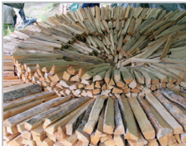
Figur 13. Legging av mila. Her har mila vokst betraktelig – datoen er 28.juni. Skyggen på bildet kommer av at vi hadde slått opp en presenning over mila mens vi arbeidet med innlegging av veden.
