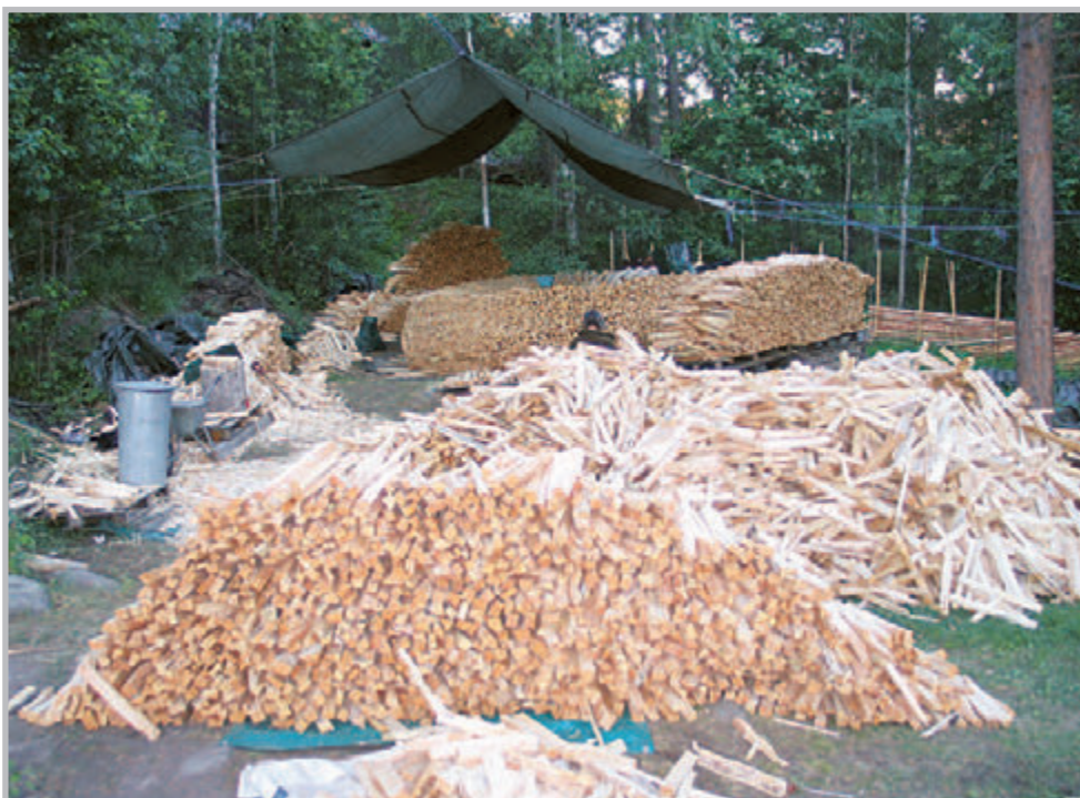
Figur 14. Legging av mila. Her sees mila i bakgrunnen under presenningen den 29.juni – og i forgrunnen har vi fått nye forsyninger med ved. Vi sorterte veden i tre kvaliteter ved mila, etter hvert som mila ble bygget opp. Dette gikk ganske bra, men vi opplevde å bli sittende igjen med til dels meget feit spik som vi gjerne skulle plassert lengre inn i mila. Den beste kvaliteten var så homogent feit at vi ikke ønsket å spikke noe av. Middels kvalitet var uhomogen, den hadde delvis svært feit og fin ved og delvis blåved eller tørr porøs ved. Denne brukte vi til kiler siden vi uansett ønsket å kløyve av delene med dårlig kvalitet. Den dårligste kvaliteten var homogent dårlig, dvs. virket tørr og evt. med blåved. Denne brukte vi ytterst som ringved eller brennved. Denne veden skal brenne først for å få i gang prosessen lenger inn i mila. Den brenner vanligvis opp uten selv å gi fra seg noe tjære. I noen tilfeller kan man se at både granved og annen ved kan brukes som slik ringved.
