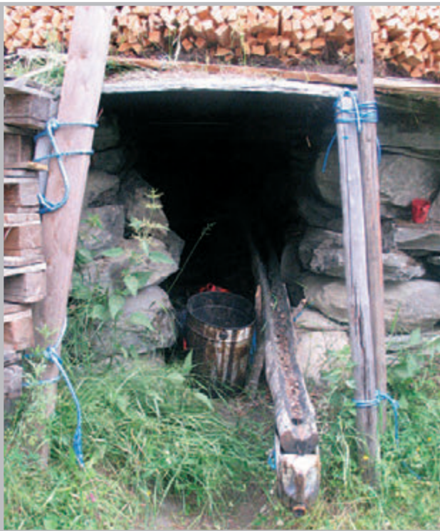
Figur 17 (over). Mila tekkes med torv rett før tenning. Lyngtorv ble hentet i skogen, like nedenfor Bygningsparken. Mer tyttebærenn blåbærlyng.
