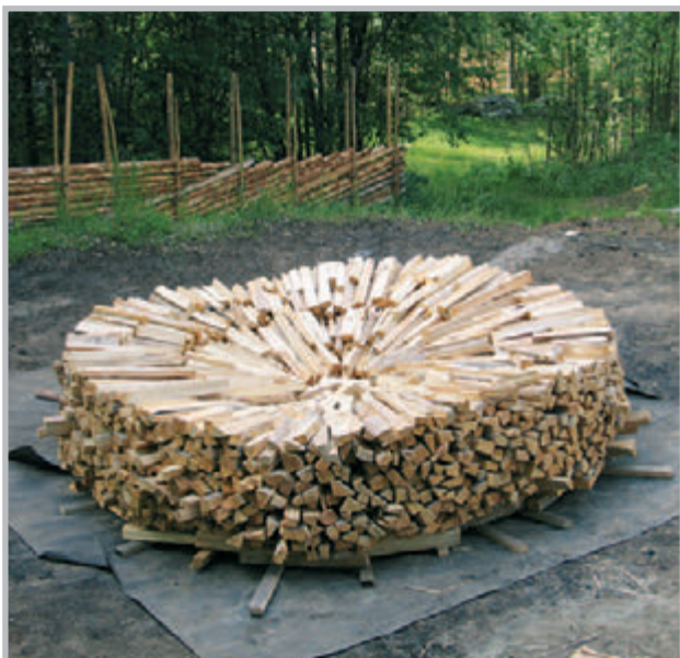
Figur 12. Legging av mila. Mila i tidlig fase den 25.juni. Det lages en slags rist midt i for å sikre at veden ligger stabilt rundt avløpet for tjæra, og at tjæra kan renne fritt. Legg også merke til at veden legges på lekter, slik at det blir luft mellom tjærepapp og den nederste veden. Dette også for at tjæra skal kunne renne fritt og for at man skal ha mulighet for noe trekk. Svært mye tid gikk med til å spikke og hogge til kiler, slik at veden ble lagt tetttest mulig.
