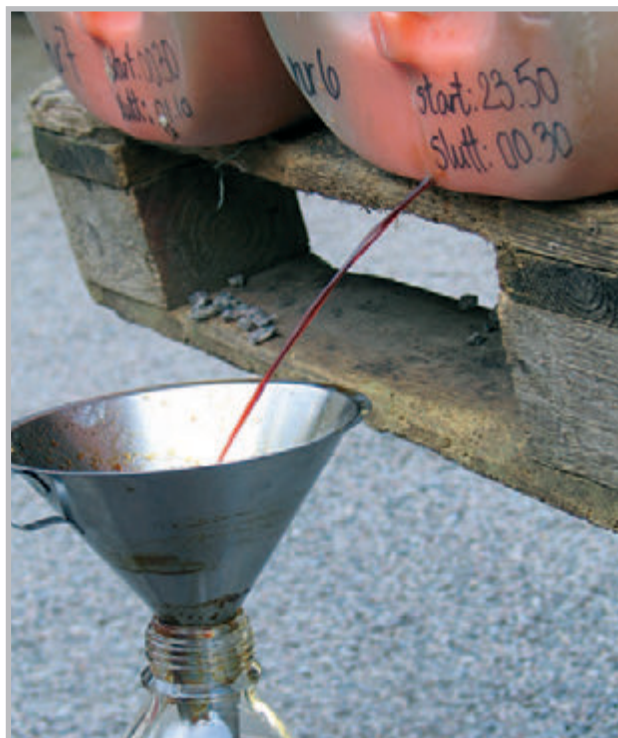
Figur 23. Vraking av tjære. Nettoutbyttet vil si det kvantum av tjære som er igjen etter at lågen er skilt fra. Lågen er en vannfase (i motsetning til tjæra som er en såkalt organisk fase) og skiller seg derfra fra tjæra etter kort tids lagring. Lågen er tyngre enn tjæra og synker derfor til bunns i dunken. Vraking er betegnelsen som brukes fra gammelt av på det å skille lågen fra tjæra, slik som dette bildet viser. Mengden låg ble på 95 liter, slik at bruttoutbyttet fra mila var 770 liter og nettoutbyttet 675 liter.
