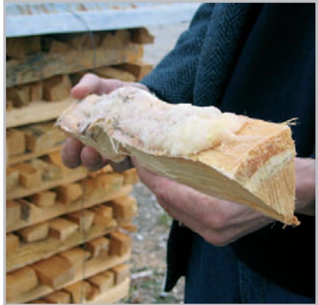
Figur 10. Kapping og kløyving. En meget feit og fin tyristikke. Kaker av harpiks på utsiden av veden, og harpiksmettet ved ytterst i yteveden.
