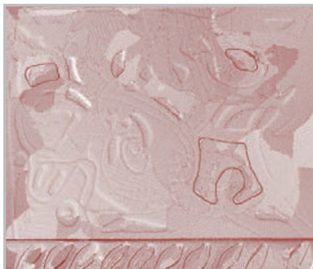
Figur 4. Data fra Archaeoptics første skanning av prøveplaten. Modellen består av 202387 punkter som hver viser avstand fra skanneinstrumentet. Modellen representerer på denne måten en overflatemodell av platen med en svært nøyaktig angivelse av overflatens terrengformer. Legg merke til at punkttettheten er ujevnt fordelt. På enhetlige flater er avstanden mellom punktene større (her opp til 1,6 mm) enn i bratte partier der punktene ligger helt ned til 0,02 mm fra hverandre. Skanning nr. 2 ble utført med høyere punkttetthet (største punktavstand 0,6 mm) og ga en modell med 892571 punkter.
