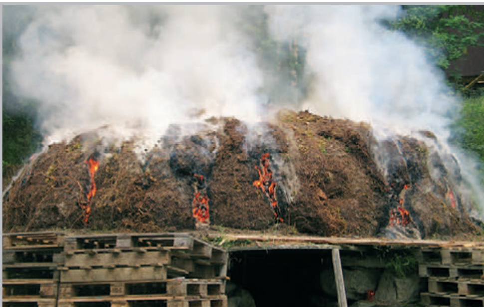
Figur 16 (til venstre). Mila tekkes med torv rett før tenning. Åpningen av mila sett fra nedsiden. Avløpet for tjæra består her av et loddrett stilt jernrør som går fra bunnen av mila og gjennom ned i tunnelen, hvor den leder tjæra ned til denne åpne rennen som går fra midt under mila og ut til et oppsamlingskar.
