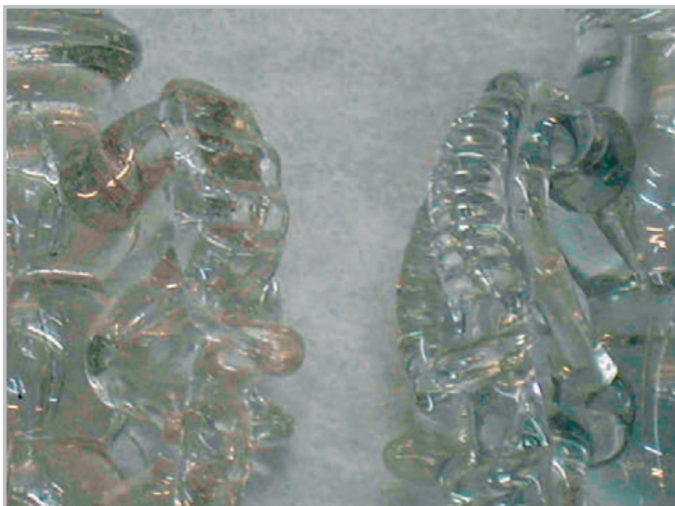
Figur 6. To kronespir produsert av ulik glasmasse: Godset i delen til venstre er nokså ureint, medan i delen til høgre er glasmassen relativt fri for luftbobler og partiklar. På grunnlag av dette og andre indikasjonar er delen til venstre klassifisert som "truleg kopi" og delen til høgre er vurdert som "truleg original". Foto: A. Bjørke, NIKU 2004.
