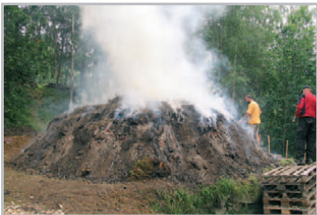
Figur 19. Tjærebrenning. Her har mila falt litt sammen, og det har begynt å danne seg aske. Vi har også kastet på såkalt "kullstubb" i stedet for mer torv, for å dempe varmen med. Kullstubb er rester av trekull og aske fra siste tjærebrenning i bygningsparken. Jan Michael Stornes, NIKU (i gul t-skjorte) og Egil Fallinggen, Skjåk, passer mila.
