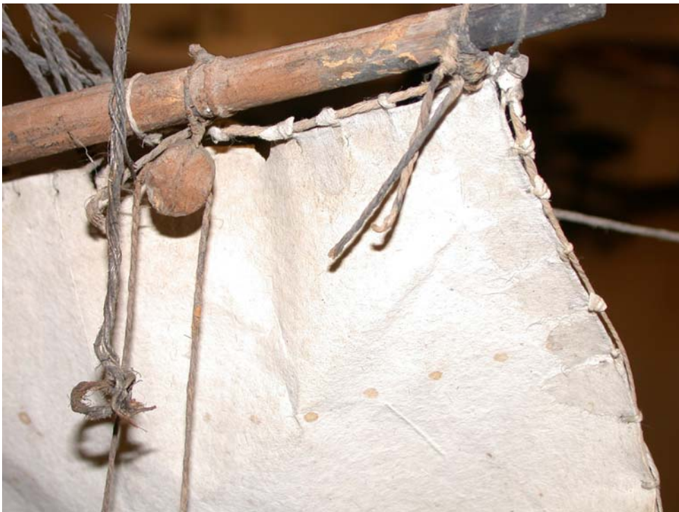
Fig.15 – Viser trådsømmen som seilene er montert med. Her kan man også se avrevne fester på råen av både originale og sekundære riggfester. Foto Malou Genfors 2006.
