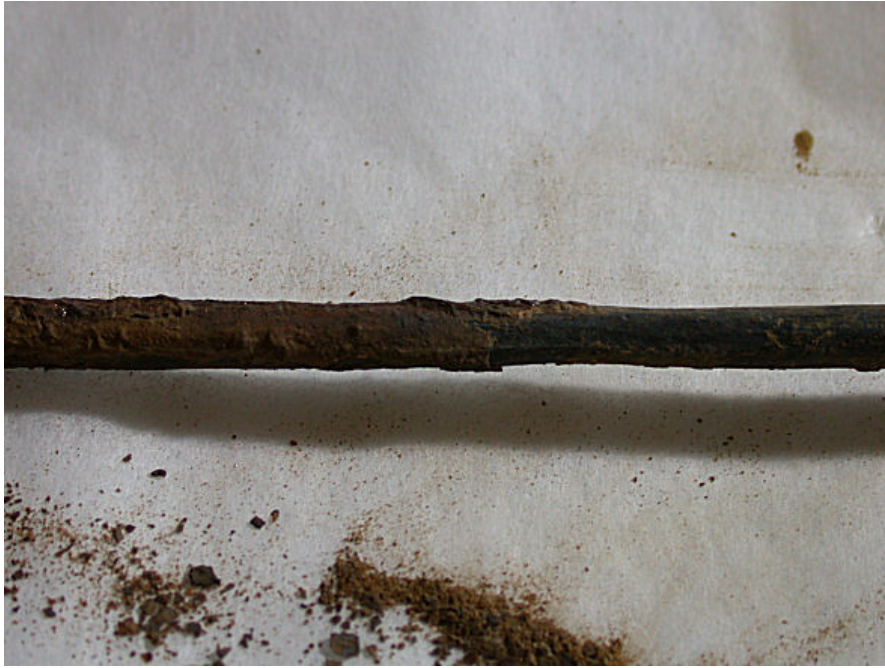
Fig.13 – Viser metallet etter at det korroderende laget på høyre halvdel er fjernet mekanisk ved hjelp av skalpell og glassfiberbørste. Foto Malou Genfors 2006
