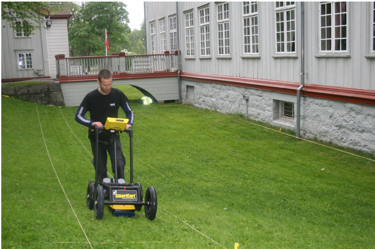
Figur 2 - Senors & Software systemet i bruk ved Eidsvollsbygningen. Radarantennen er festet rett over overflaten på en glideplate. På kontrollenheten foran operatøren vises profildata og andre viktige måleparametre
