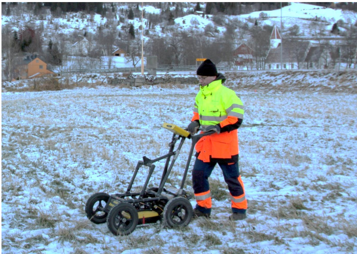
Figur 7 – Senors & Software systemet i bruk ved Auduns borg. Radarantennen er festet rett over overflaten på en glideplate. På kontrollenheten foran operatøren vises profildata og andre viktige måleparametre.
