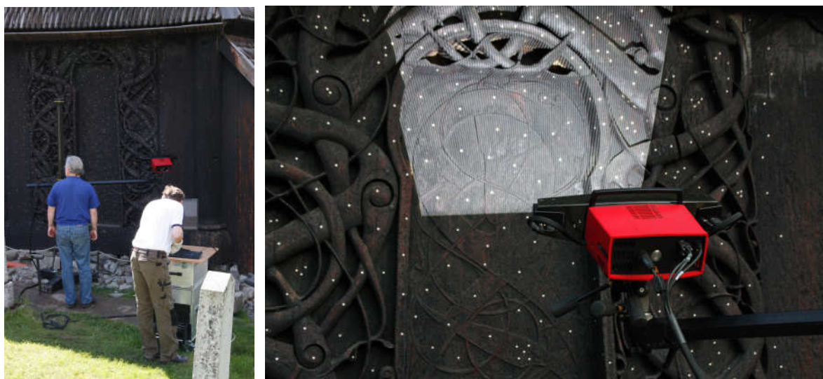
Figur 2 – Bruk av ATOS GOM III fotoskanner til detaljskanning av nordportalen. Foto: Knut Paasche, NIKU
