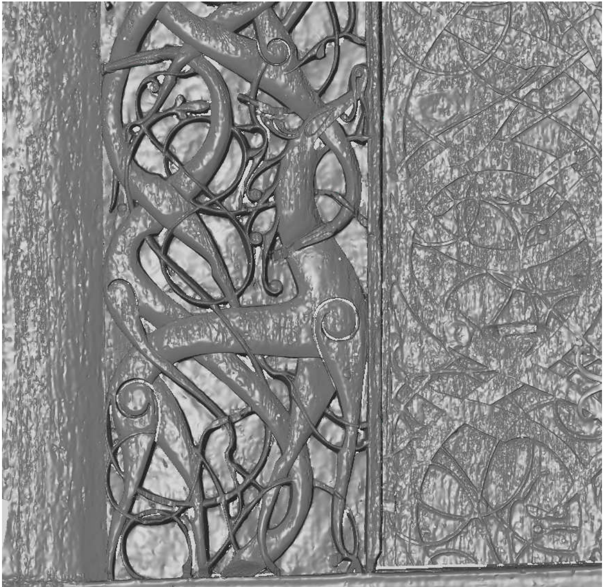
Figur 12 - Detalj fra datasettet fra fotoskanneren. Bildet viser en del av Urnes-portalen generert som en overflate i STL-format.
