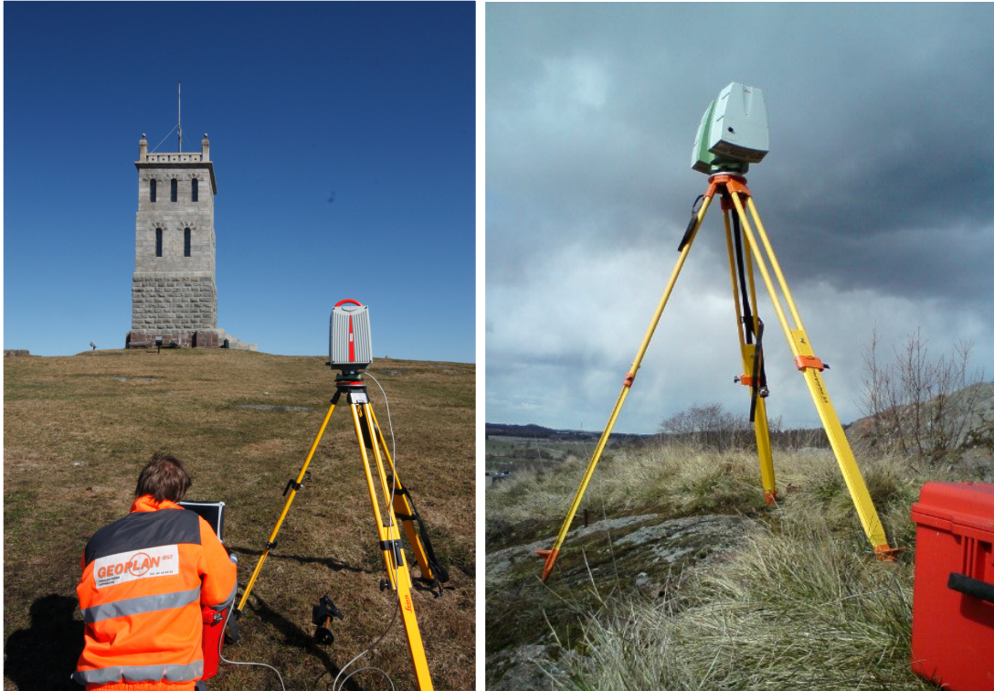
Figur 3 – Til venstre: Leica HDS6000 faseskanner Foto: NIKU/Knut Paasche. Til høyre: Leica C10 pulsskanner Foto: NIKU/Lars Gustavsven
