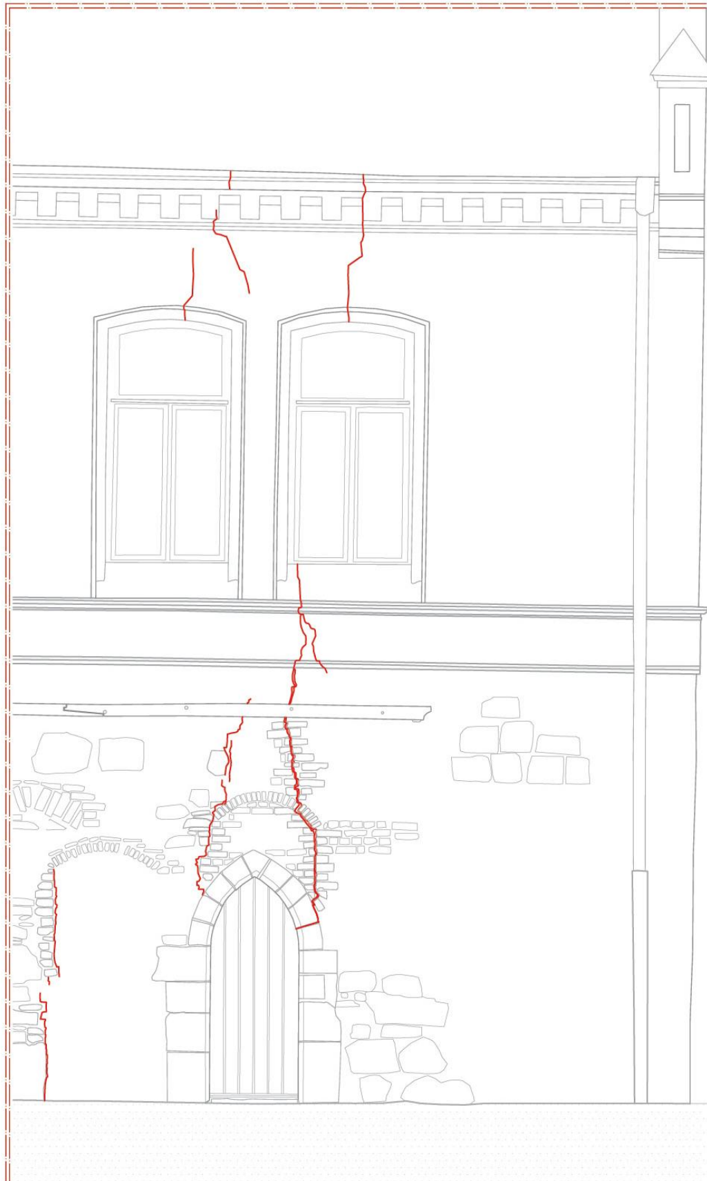
Figur 11 - Uttegning av fasaden med sprekken
