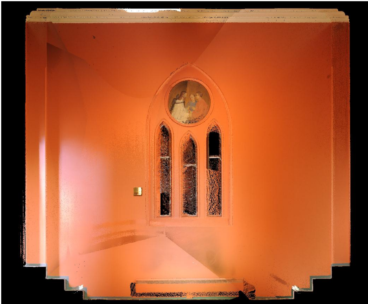
Figur 4 - Punktsky fra vegg i inngangspartiet. Utsnittet er laget i RISCAN PRO ® og viser punkter med forskjellige RGB-verdier.
