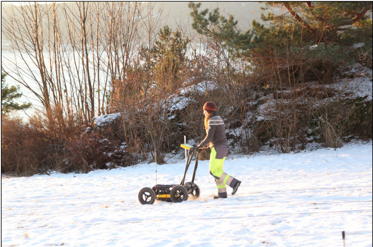
Figur 2- Georadarundersøkelse på Nedre Ramme. Utstyret som er brukt er et Sensors and Software Noggin 500 enkeltkanalssystem. Foto: LG/NIKU
