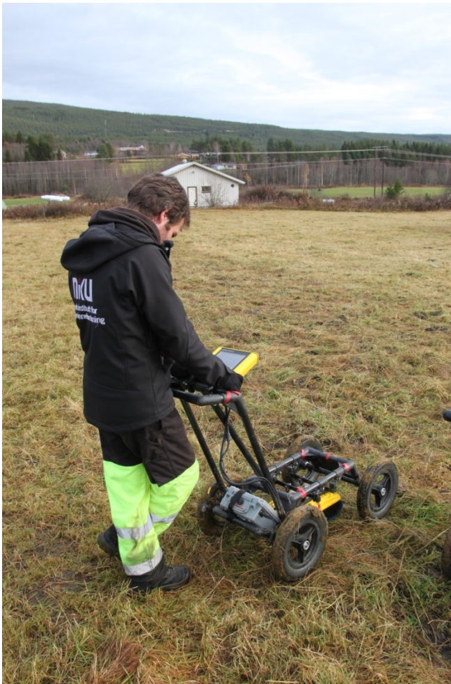
Figur 7 - Sensors & Software systemet i bruk ved Prestegårdsjordet. Radarantennen er festet rett over overflaten på en glideplate. På kontrollenheten foran operatøren vises profildata og andre viktige måleparametre. Foto: MK/NIKU
