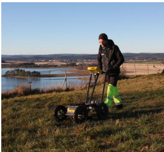
Figur 7 - Georadarsystem av typen Sensors and Software Noggin Plus 500 i bruk på Slottsfjellet. Foto: MK/NIKU.
