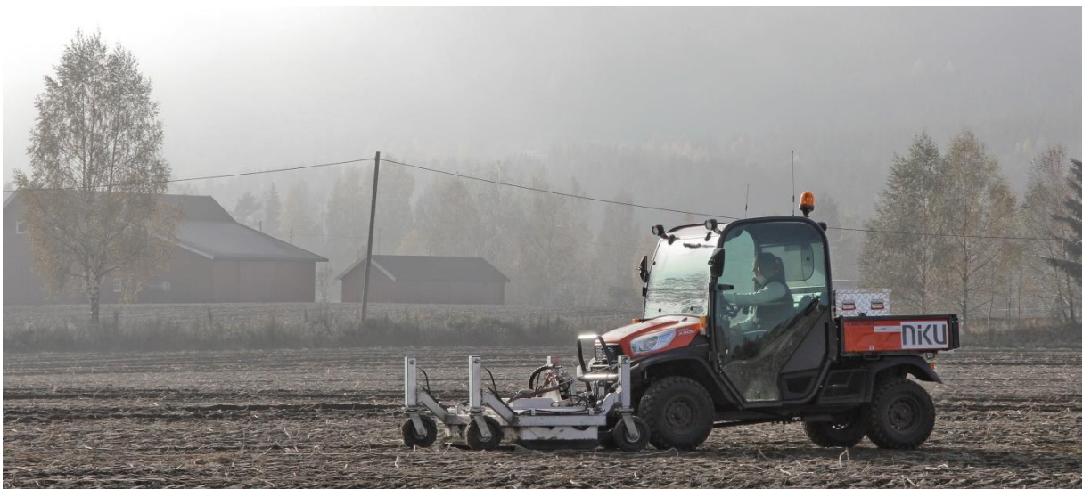
Figur 6 – Motorisert georadarsystem av typen MALÅ MIRA III. Systemet sitter foran et terrengkjøretøy, og består av 17 radarantenner plassert med 10,5 cm mellomrom (Foto LG/NIKU).
