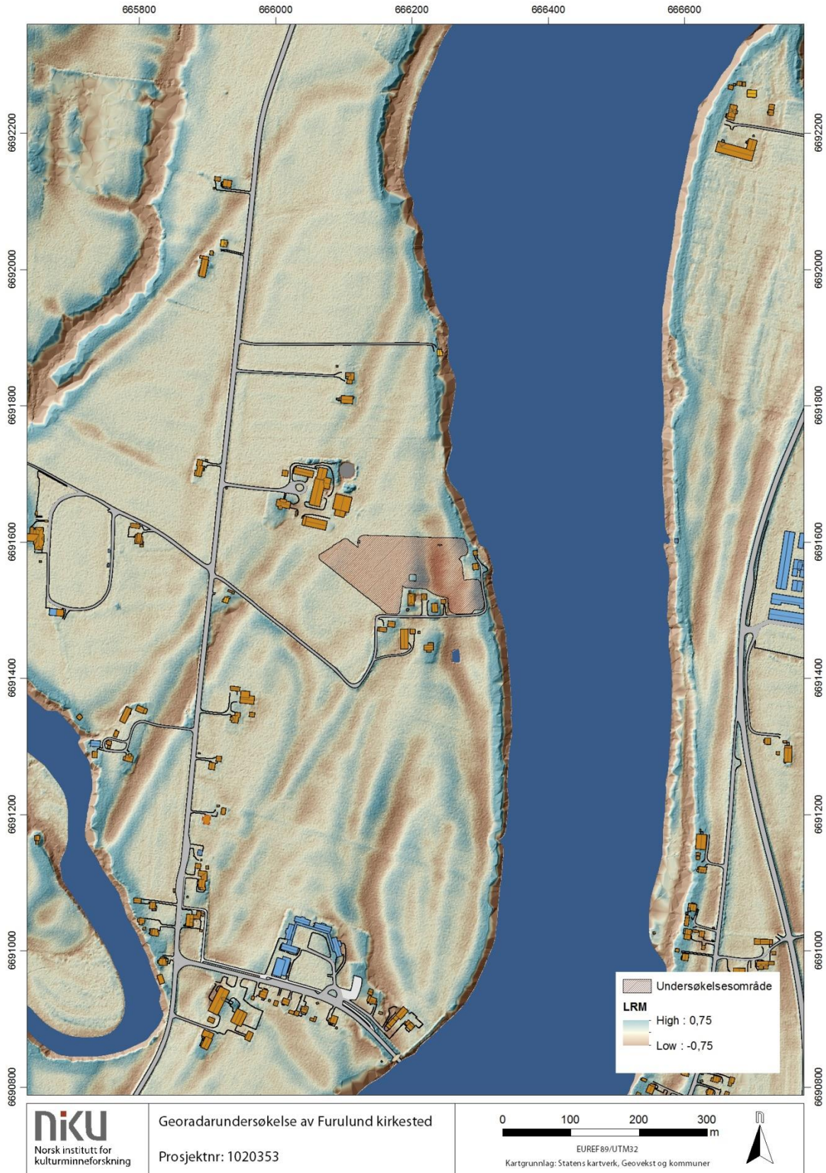
Figur 4 – LIDAR-data over undersøkelsesområdet og omliggende landskap. Legg merke til de lineære elveterrassene som strekker seg diagonalt gjennom området. Dette er sannsynligvis spor etter flomepisoder som har funnet sted i området før kirkestedet har blitt anlagt. Local Relief Model (LRM) 60% transparens over Hillshade.
