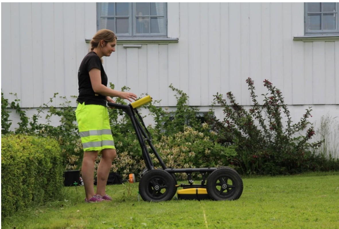
Figur 10 - Enkeltkanals radarsystem brukt under undersøkelsene ved Hovinsholm. Radarantennen er av typen Sensors and Software Noggin 500, montert i en såkalt SmartCart-konfigurasjon. Se for øvrig vedlegg A for utfyllende teknisk informasjon om systemet.
