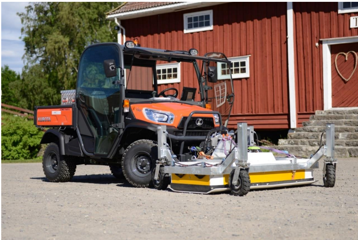
Figur 9 - Motorisert radarsystem brukt under undersøkelsene ved Hovinsholm. Systemet er av typen MALÅ MIRA, og drives frem av et Kubota terrengkjøretøy. 17 radarantenner er plassert med 10 cm mellomrom i den hvite og gule kassen foran på kjøretøyet. Se for øvrig vedlegg A for utfyllende teknisk informasjon om systemet.
