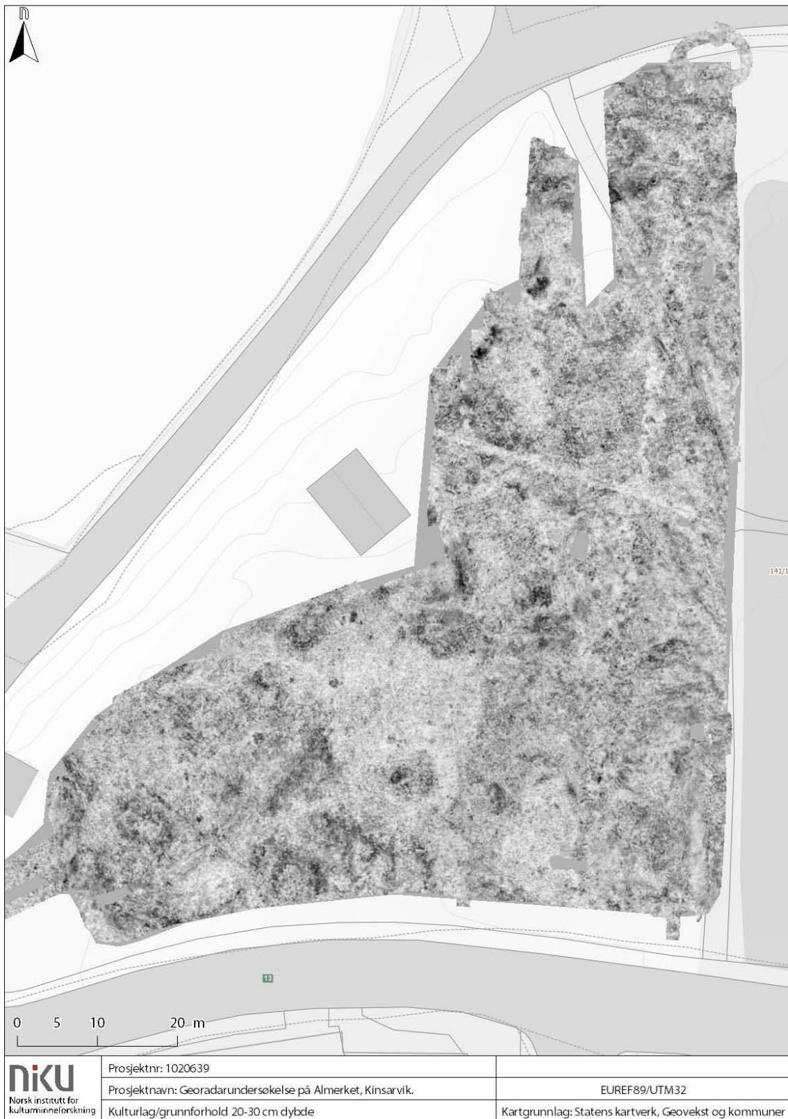
Figur 7: De tykke kulturlagene fremstår som større anomalier av middels til kraftig reflekterende respons. Grunnen fremstår derfor svært heterogen i de geofysiske dataene. Her avbildet i dybdeskive 20-30 cm under overflaten.
