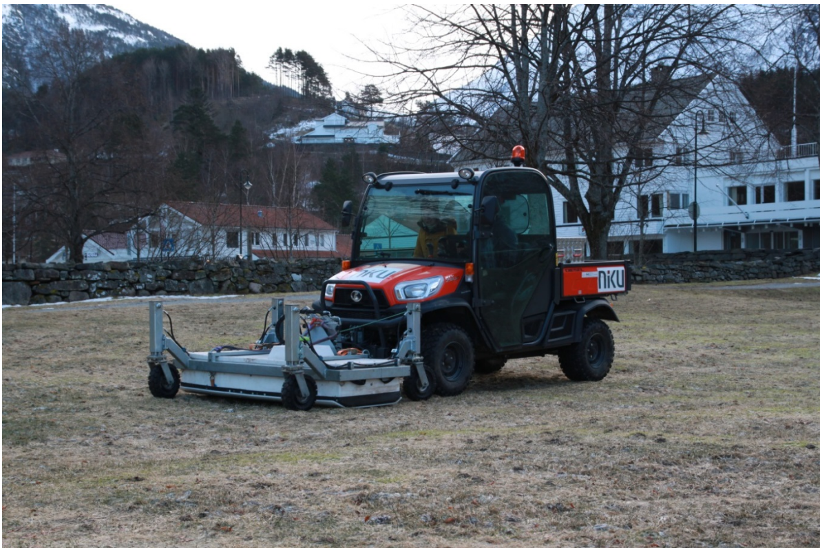
Figur 5: Motorisert georadarsystem, Malå MIRA III, som ble anvendt i undersøkelsen på Almerket. Foto: LG/NIKU.
