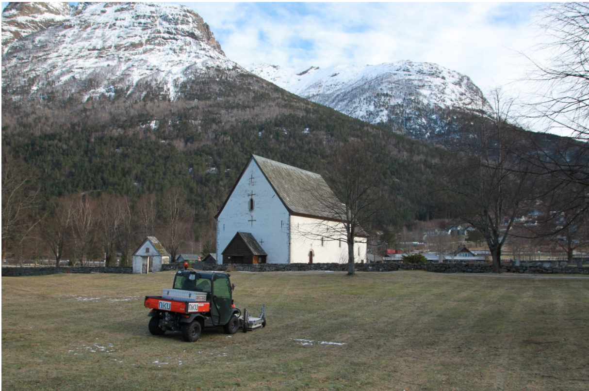
Figur 1: NIKUs motoriserte georadarsystem, MIRA III, under feltarbeidet på Almerket. I bakgrunnen ses Kinsarvik kirke. Foto: LG/NIKU.
