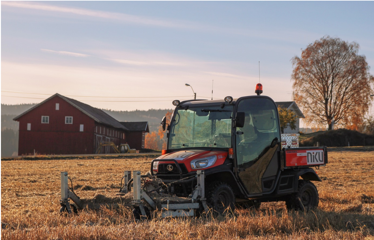
Figur 4: 16-kanals georadarsystem av typen MALÅ MIRA. Foto: EN/NIKU.
