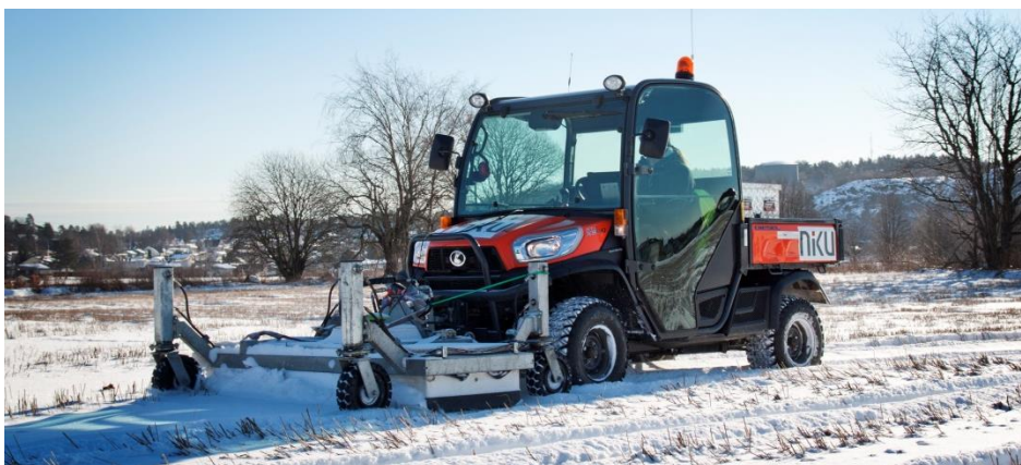
Figur 3 - Georadarsystem av typen MALÅ MIRA i bruk ved Haukerød.
