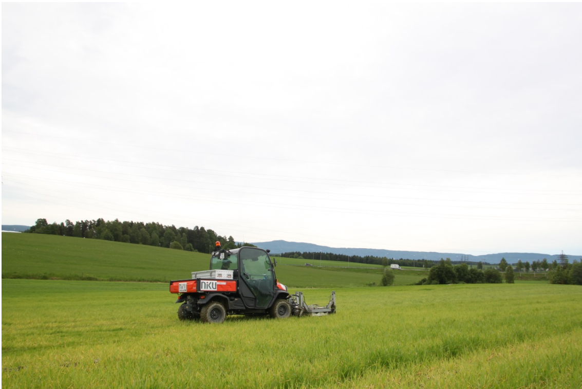
Figur 18: Georadarundersøkelse på Ve. Bildet er tatt mot SV. Foto: NIKU.
