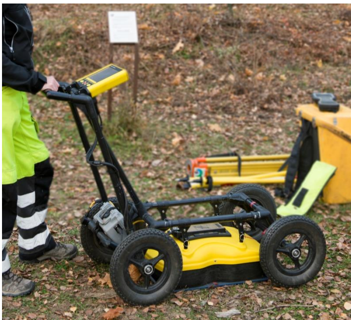
Figur 6 - Sensors & Software Noggin georadar montert i SmartCart-konfigurasjon. Antennen, som i dette tilfellet er av en variant med 250 MHz senterfrekvens, sitter montert mellom hjulene på trallen. På denne er også montert strømforsyning (12V batteri) og en kontrollenhet der datainnsamlingen styres. Foto: EN/NIKU.
