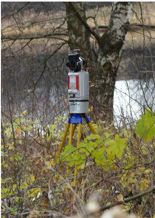
Figur 7 - Laserskanner av typen Riegl VZ-400 i bruk ved Elvsholmen. Foto: EN/NIKU.
