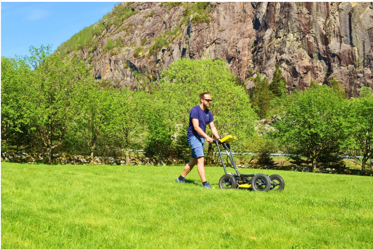
Figur 4: Georadarutstyret S&S Noggin500 som ble anvendt til undersøkelsen ved Heskestad gamle kyrkjegard. Foto: EN/NIKU.
