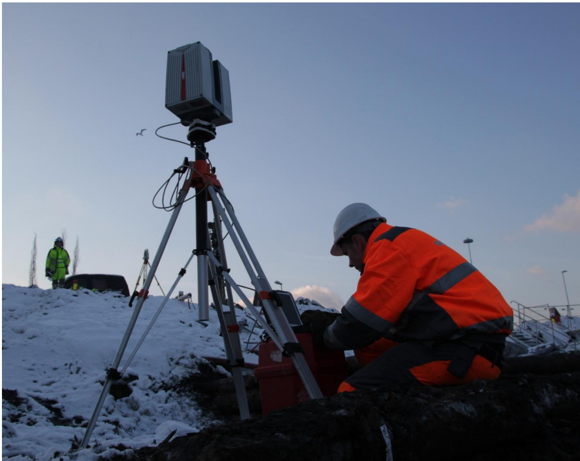
Figur 1 - Laserskanning i felt. Bildet viser en laserskanner av typen Leica HDS6000. Foto: Lars Gustavsen, NIKU
