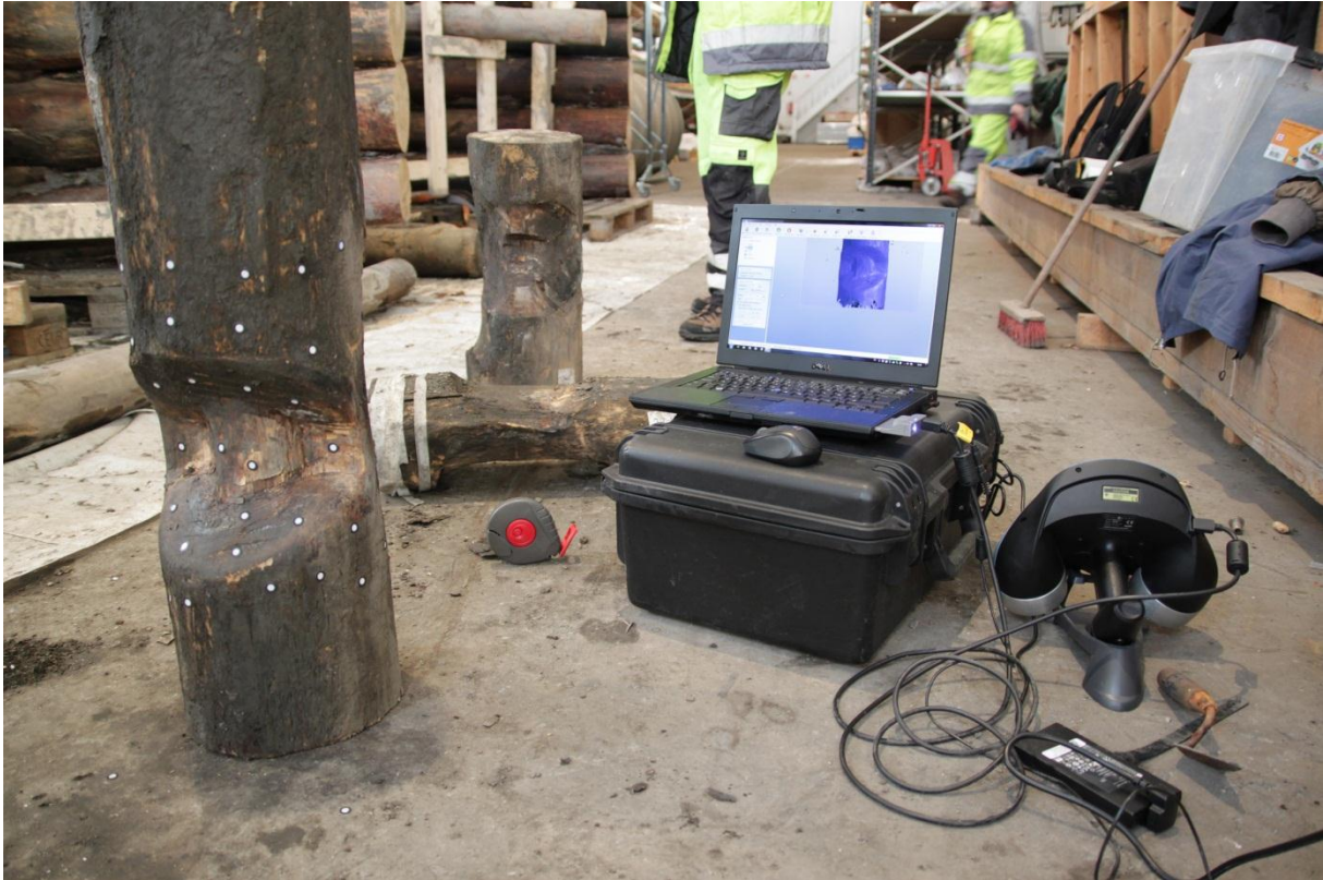
Figur 2 - Laserskanning av tømmerkonstruksjoner etter demontering. Instrumentet kan sees til høyre i bildet. Legg merke til referansepunktene på tømmerkonstruksjonen til venstre. Foto: Lars Gustavsén, NIKU
