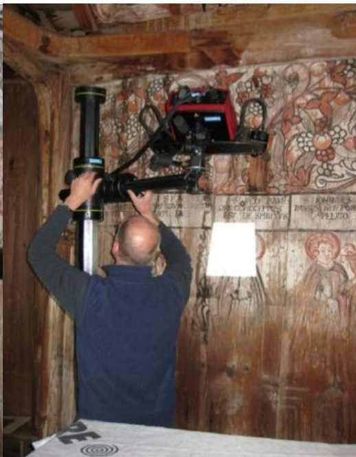
Innstilling av den optiske skanneren
