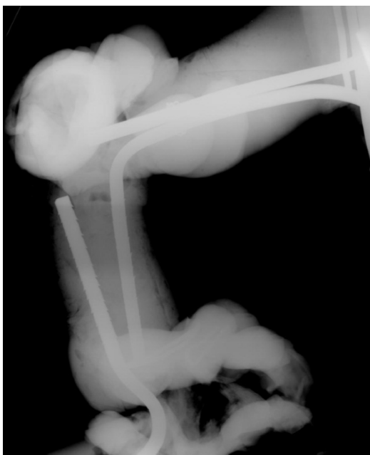
Figur 3. "Genisverm", original gipsskulptur av Gustav Vigeland, Vigeland-museet. På røntgenbildene sees armeringsjernet og dets plassering i gipsen. Foto: NIKU, 2009.
