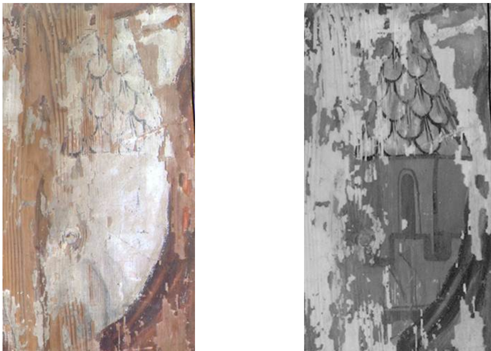
Figur 3A. Detaljopptak normalt lys uten løsemidler. 3B. Detaljopptak IR med xylen. Foto: Edwin Verweij og Barbro Wedvik, NIKU 2008.
